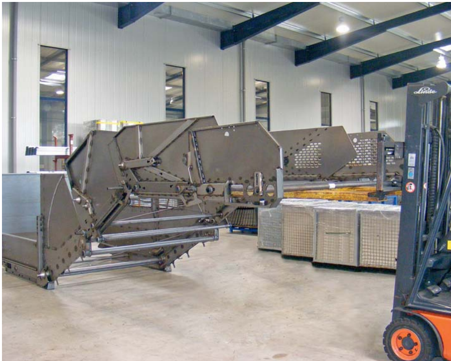
Hier geht's zur Sache: Große Schweißbaugruppe von Knake kurz vor der Auslieferung an die Grimme Landmaschinenfabrik in Damme für den Einsatz in den weltberühmten Kartoffelvollerntern.
